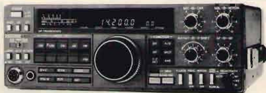
TS 440 S Ricetrasmittitore HF - Copertura continua AM-FM-CW-SSB 220 W P.e.P.
